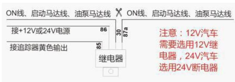
**警告:** 断油断电会使行驶中的汽车转向和刹车失去助力,从而有引发交通事故和人员伤害的风险,请慎用此功能,推荐把断电器接在启动马达上,这样使汽车不能发动而不是熄火。
