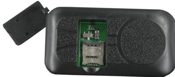
**4.2、安装 SIM 卡（本机使用中 SIM 卡 Micro 卡）：**设备需要插入一张 2G GSM 电话卡，（需要开通 5 元包 30M 数据流量套餐，一般设备每月消耗 20-30M 数据流量，也可以选用纯数据流量卡（无语音无短信），可上网查询，但不能发短信和打电话定位报警）。
