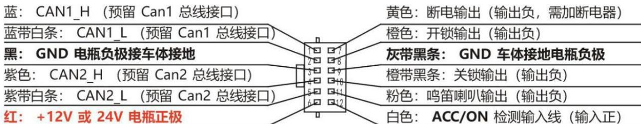
1、CAN 线为原车总线的接口线。
