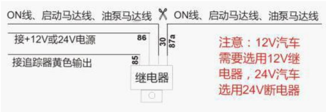
**警告：**断油断电会使行驶中的汽车转向和刹车失去助力，从而有引发交通事故和人员伤害的风险，请慎用此功能，推荐把断电器接在启动马达上，这样使汽车不能发动，但是不能使发动机熄火。
