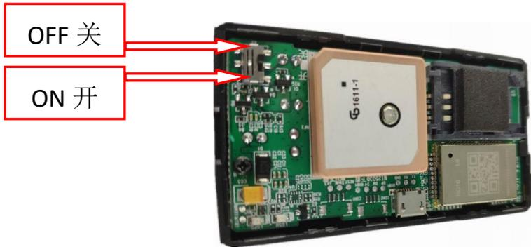
开机后定位器自动工作，LED 灯会闪烁，合起外壳，把定位器放在外面，5 分钟后看定位器的位置有无更新，如位置已经更新，说明定位器正常，把外壳合好并把定位器固定到想要安装的位置上。
